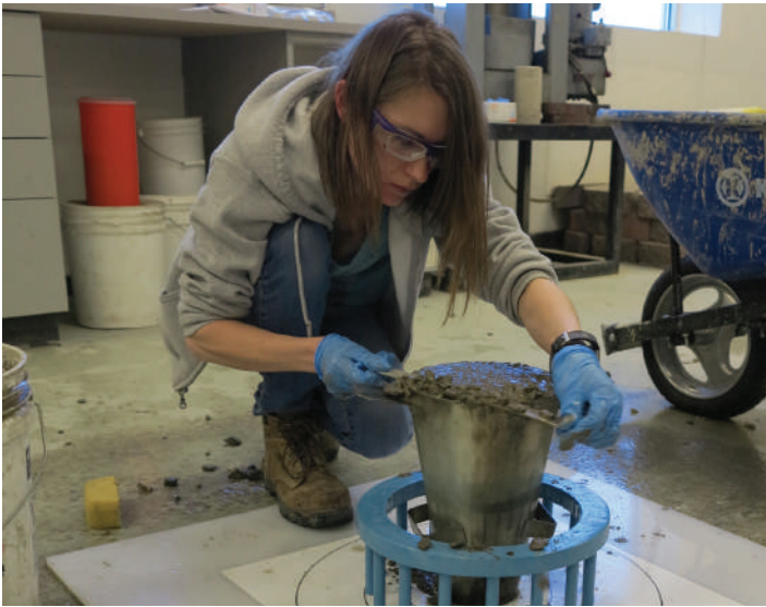
Fig. 1: Certificación de técnico en ensayo de concreto autocompactable durante un evento de nieve.
