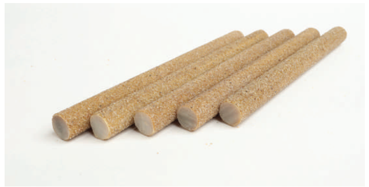
Fig. 4: Barras de refuerzo de fibra de vidrio recubiertas de arena utilizadas en el proyecto.
