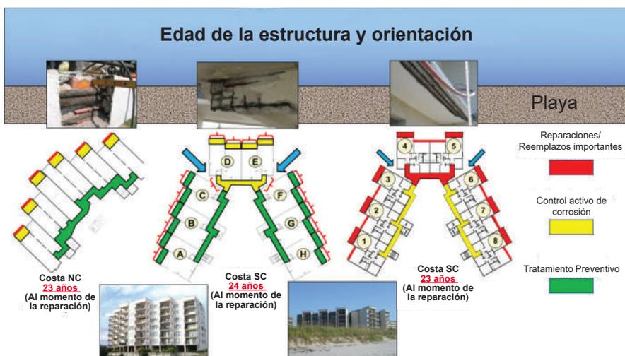
Fig. 6: Reparaciones/reemplazos importantes necesarias y control activo de la corrosión para estructuras en ambientes costeros después de aproximadamente 20 a 25 años de servicio.
