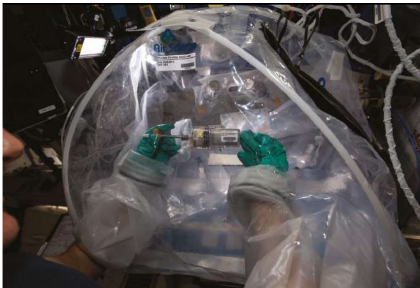
Fig. 4: Realización del experimento MASON/ISS de endurecimiento del concreto por el astronauta alemán de la ESA Matthias Maurer. El mezclador es operado dentro de una guantera temporal. Sesenta y cuatro de estas muestras fueron procesadas en febrero de 2022 y ahora están siendo analizadas
