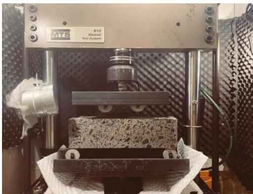
Fig. 3: Configuración de las pruebas de fatiga
