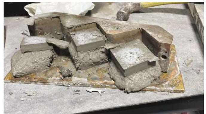
**Figura 7: CAR curado lentamente en temperaturas bajas (foto tomada 24 después de haber fundido). La temperatura ambiente estimada fue de 55°F (13°C)**
