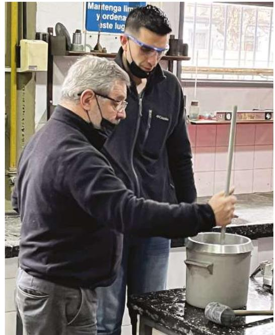
**Figura. 3:** Luco comentando el procedimiento sobre la densidad del hormigón fresco (IRAM 1582)
