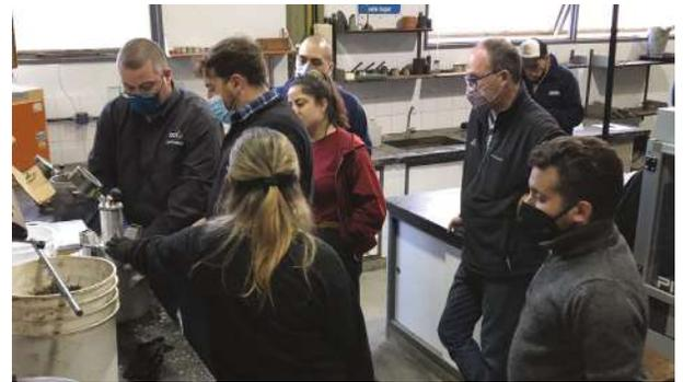
**Figura. 2:** Mohler demostrando la aplicación correcta de la IRAM 1602 (Contenido de Aire por el Método de Presión) al equipo de Examinadores Suplementarios
