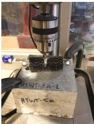
Figura 3: Preparación para la prueba de abrasión superficial ASTM C944/C944M
