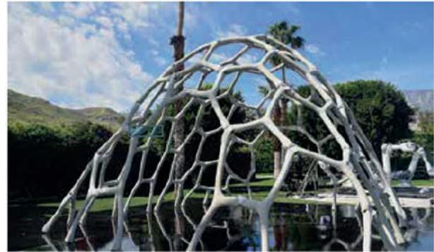
**Fig. 8:** El Mars Canopy se construyó sin barras de refuerzo<sup>20</sup>
