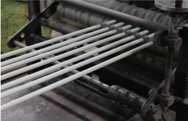
**Paso 2:** el proceso de pultrusión crea barras compuestas de fibra de vidrio/éster de vinilo en longitudes de hasta 24 m (80 pies).
