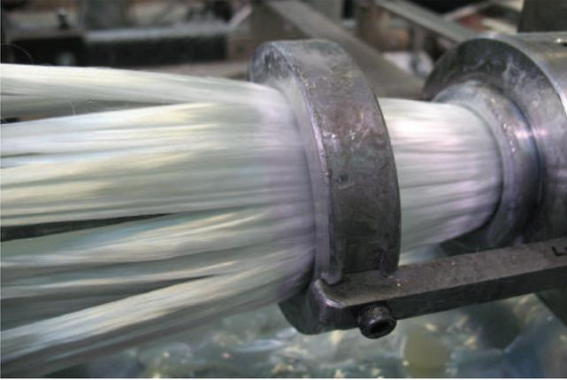
**Paso 1:** la fibra de vidrio se introduce en la matriz pultruida y se inyecta con resina en un proceso de moldeo cerrado.
