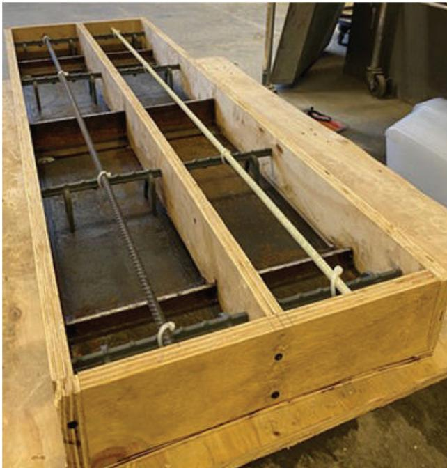
**Fig. 6: Encofrado, barras de refuerzo e iniciador de grietas para la preparación de la muestra de ensayo de agrietamiento por contracción**
