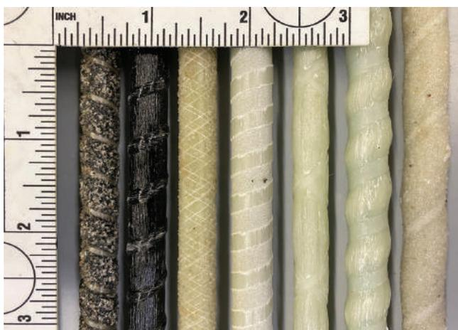
Fig. 1: Ejemplos de barras de FRP con distintas características superficiales
