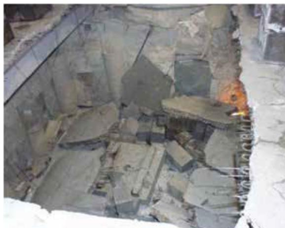
**Fig. B:** Foto de la pág. B-3 de la referencia 19. El título original dice: "Carga colapsada a los 3 minutos y 55 segundos después de que finaliza la exposición al fuego"
